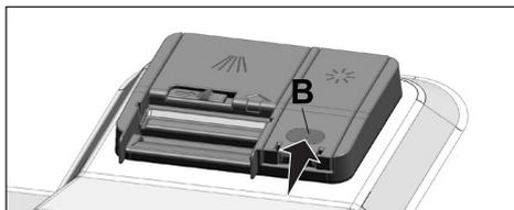
4. Falls nach dem Spülen Flecken am Geschirr verbleiben, stellen Sie eine höhere Stufe ein. Sollte eine bläuliche Färbung nach dem Abwischen des Geschirrs von Hand zurückbleiben, wählen Sie eine niedrigere Stufe. Ihr Gerät ist ab Werk auf Position 3 voreingestellt.
