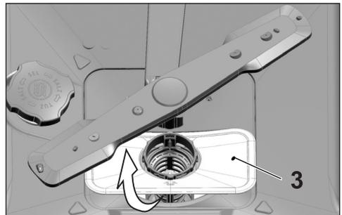
3. Drücken Sie die beiden Sperren am Grobfilter nach innen, lösen Sie den Grobfilter von der Baugruppe.
