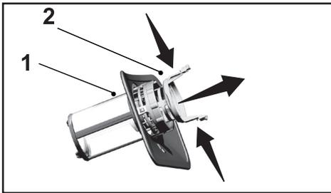
4. Reinigen Sie alle drei Filter mit einer Bürste unter fließendem Wasser.
