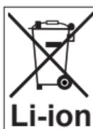
Dieses Symbol an Akkus/Batterien oder an der Verpackung zeigt an, dass der Akku oder die Batterie nicht über den herkömmlichen Hausmüll entsorgt werden darf.
