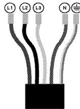
2. Bei Dreiphasenanschluss erfolgt der Anschluss der Kabel wie folgt:
