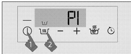
3. Die entsprechende Kochzone wird nach der ersten Berührung bei der Erwärmen-Stufe aktiviert. Die Symbole "P1" und "⏸" werden angezeigt.
