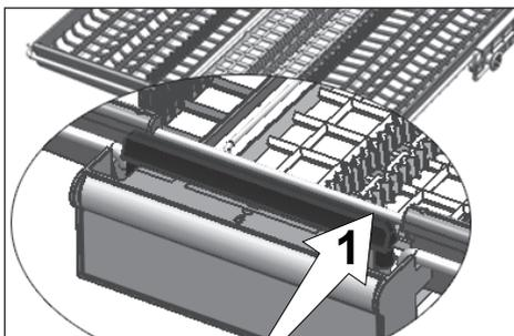
In Modellen mit partieller Bewegungsfunktion können Sie die zentrale Ablage des Korbs durch Drücken der Stange (1) am Griff auf die unterste Position einstellen. Damit wird das System freigegeben. Dadurch können die rechten und linken Ablagen als bewegliche Teile genutzt werden. Der durch die seitlichen Ablagen geschaffene Platz ermöglicht die Beladung des oberen Korbs mit langen Gegenständen.
