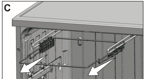
Schienenkappen wieder in der Ursprungsposition anbringen. Schienen im Gerät zur Seite drehen, bis sie richtig sitzen (D).
