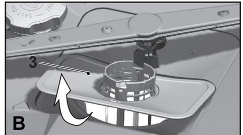
3. Beide Sperren am Grobfilter nach innen drücken, Grobfilter von der Baugruppe lösen (B).
