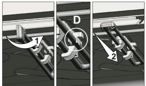
Zum Wiedereinsetzen des oberen Besteckkorbes dieselben Schritte in umgekehrter Reihenfolge ausführen.
