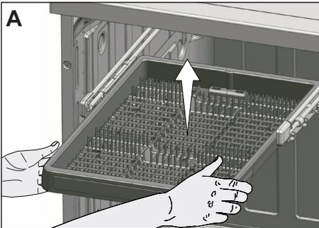
Wenn der obere Besteckkorb nicht genutzt werden soll, Schienenkappen nach außen drehen und den Korb zu sich hin herausziehen (B).
