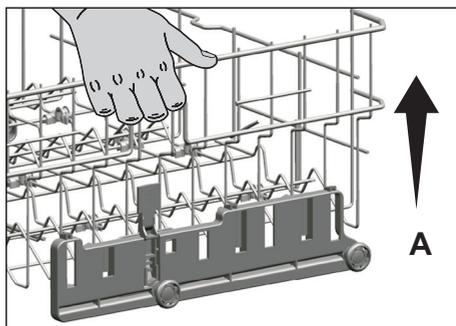
Bei der Höhenverstellung darauf achten, dass die Höhe auf beiden Seiten gleich eingestellt ist.
