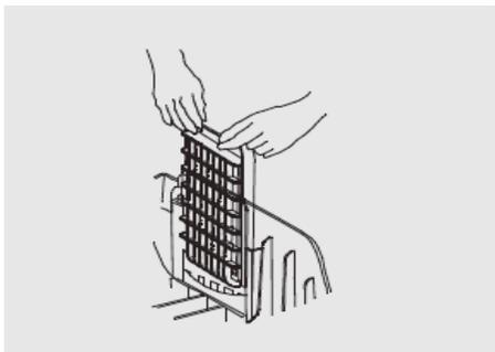
4 Secouez le filtre, puis nettoyez-le à l'eau savonneuse, rincez-le abondamment et laissez-le sécher à l'air.
