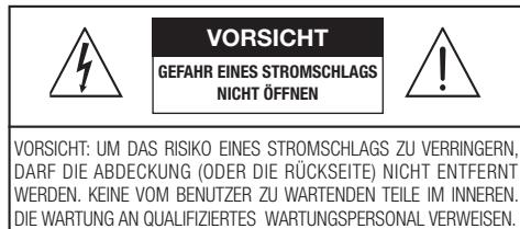
Das Blitzsymbol mit Pfeilspitze in einem gleichseitigen Dreieck soll den Benutzer auf das Vorhandensein einer nicht installierten "gefährlichen Spannung" innerhalb des Gehäuses des Produkts aufmerksam machen, die so groß sein kann, dass die Gefahr eines Stromschlags für Personen besteht.
