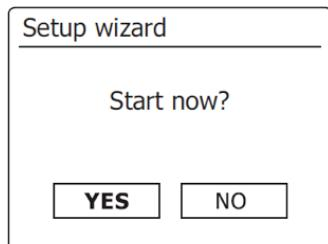
2. Verwenden Sie die Navigationssteuerelemente [ $\blacktriangle$ ,  $\blacktriangledown$ ,  $\blackleftarrow$ ,  $\blackrightarrow$ ] und [▶||] um den Einrichtungsassistenten zu starten und abzuschließen
